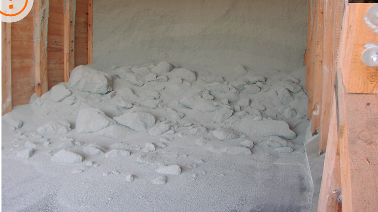
Nichtabdeckung der Ware führt zu Verbackung der Körner durch Feuchtigkeit
